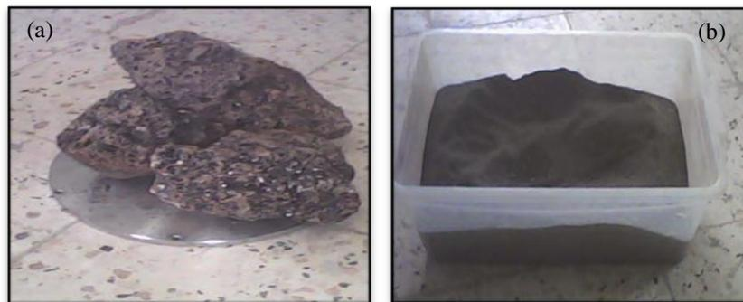
**Figure 2:** (a) Scories de la PN avant broyage; (b) Poudre de la PN après broyage.
