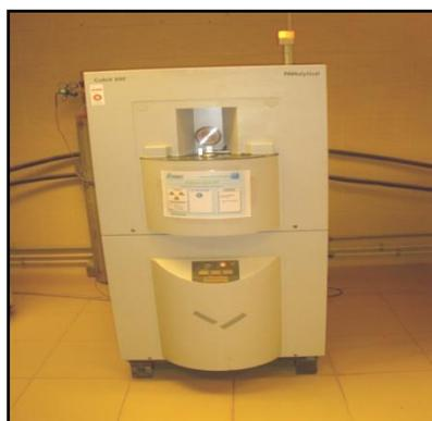
**Figure 1** : L'appareil de marque PANalytical utilisé pour la détermination des taux des oxydes du ciment.
