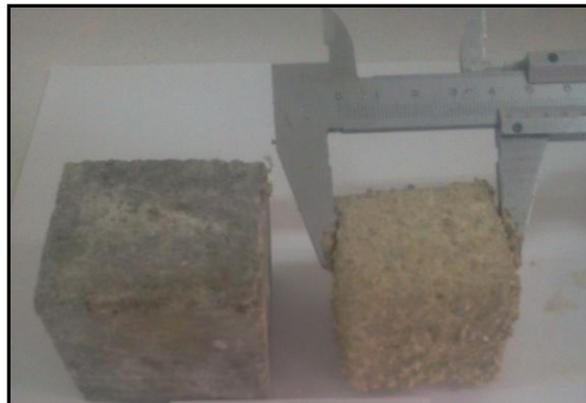
**Figure 15 :** Mesure des dimensions des échantillons.
