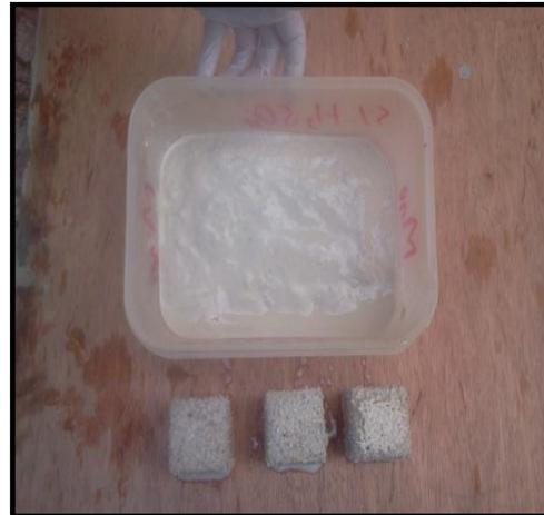
Figure 11 : Dépôt du gypse au fond du bac après 45 jours d'immersion.
