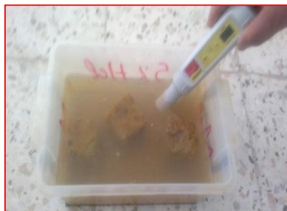
Figure 12 : Lecture du pH de la solution acide 5%  $\text{H}_2\text{SO}_4$ .
