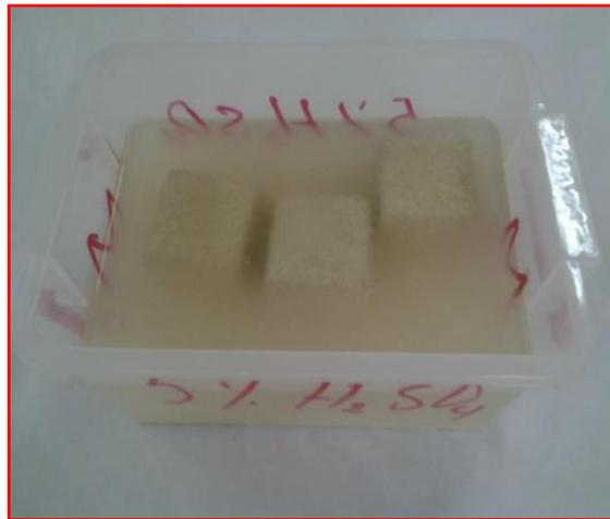
**Figure 6 :** Mortiers immergés dans la solution acide 5% H<sub>2</sub>SO<sub>4</sub> en concentration massique.
