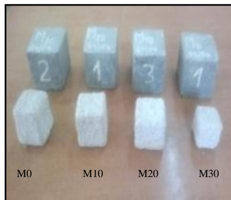
Figure 17 : Etat des éprouvettes après 105 jours d'immersion dans 5% $H_2SO_4$ .
